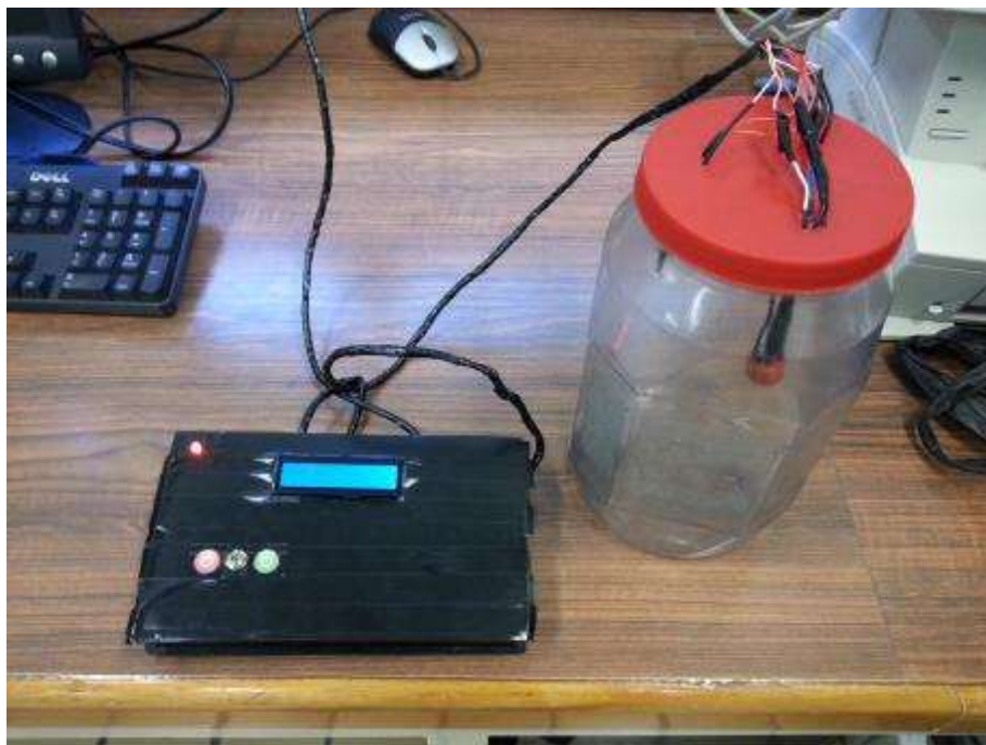
Medidor de monóxido y bióxido de carbono en ambiente controlado
