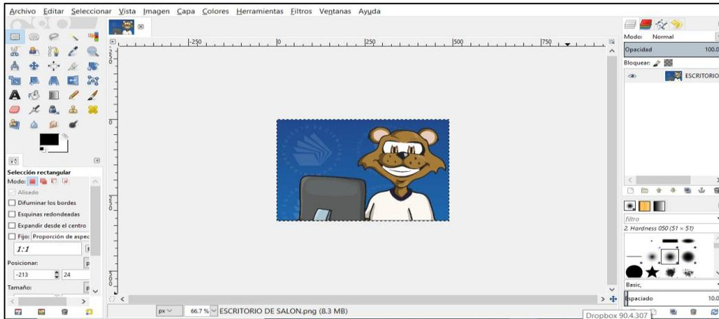
Utiliza la caja de herramientas para generar solo la imagen del puma sin fondo. Como se muestra en la siguiente figura
