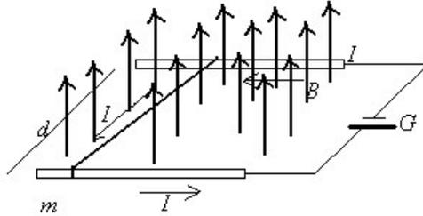
El dispositivo se encuentra en un campo magnético uniforme vertical  $B$ , en la batería  $G$  fluye una corriente constante  $I$  a lo largo del riel, a través del alambre y, de regreso por el otro riel. Encuentra la velocidad (rapidez y dirección) del alambre como función del tiempo, suponiendo que en el instante  $t = 0$  estaba en reposo.
