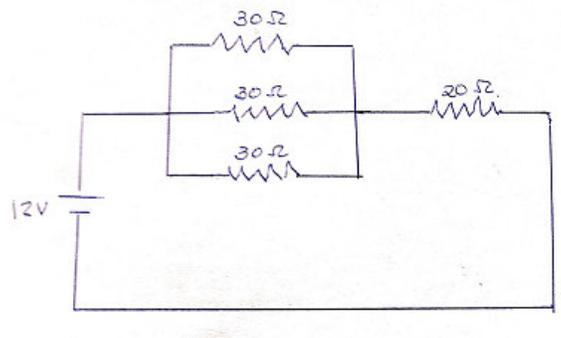
b.- La resistencia total del circuito se obtiene calculando primero la resistencia equivalente de las resistencias en paralelo:
