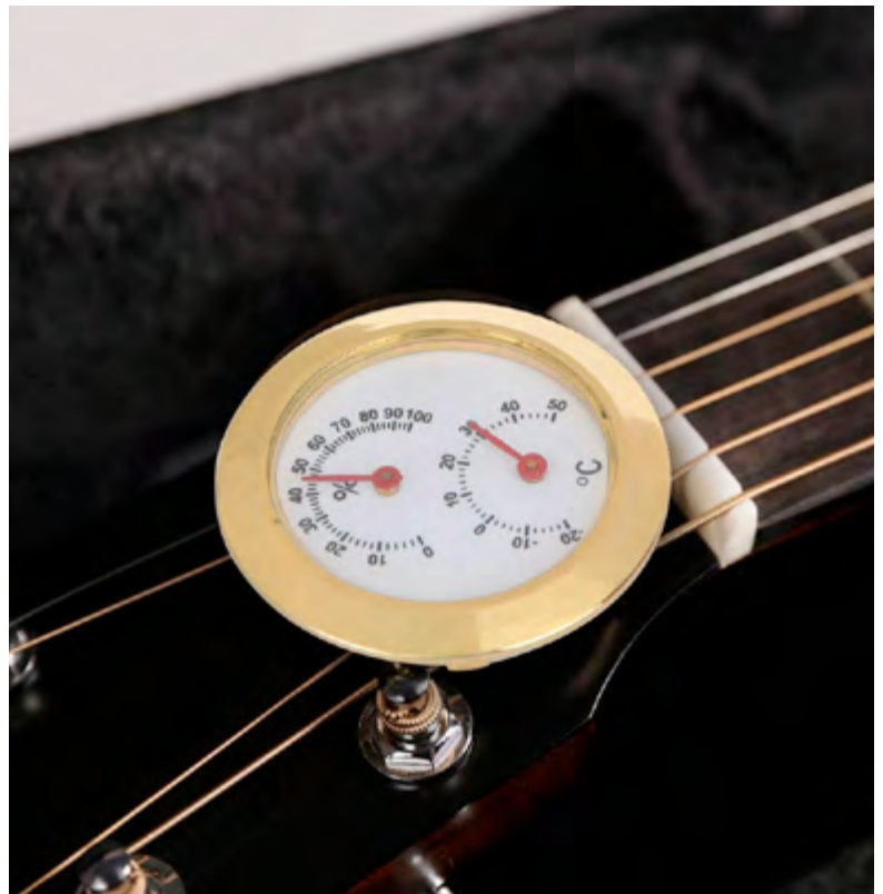
Higrómetro montado en un instrumento de cuerda, a la izquierda mide la humedad relativa (HR%) a la derecha la temperatura.
